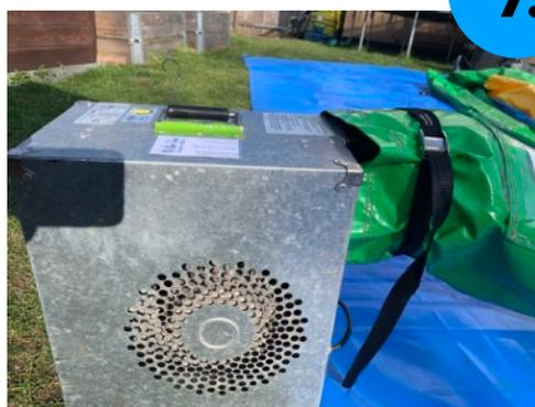
Gebläseschlauch an Gebläse anschließen. Hierbei darauf achten, dass der Schlauch keine Knicke oder Drehungen aufweist.
